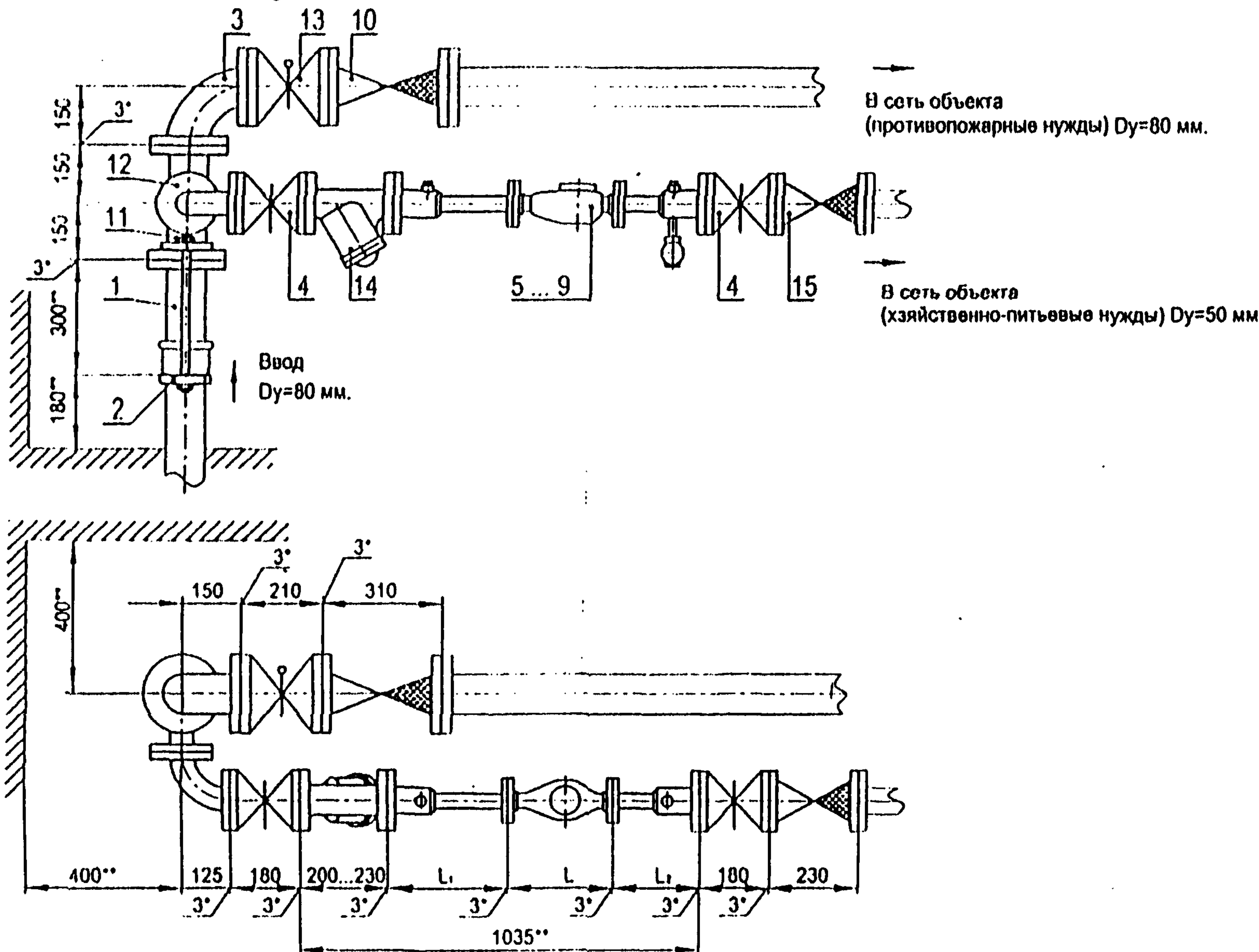
Установка счетчиков  $Dy = 20 \dots 50$  мм на хозяйствственно-питьевой линии
